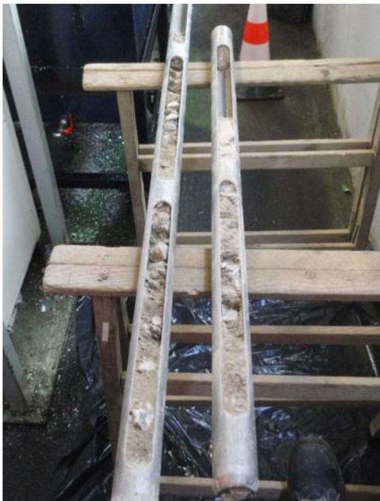
Questo sistema permette l'esecuzione di microcarotaggi (diametro 35 – 50 mm) con infissione nel terreno di aste e carotieri mediante martello dotato di massa battente.
