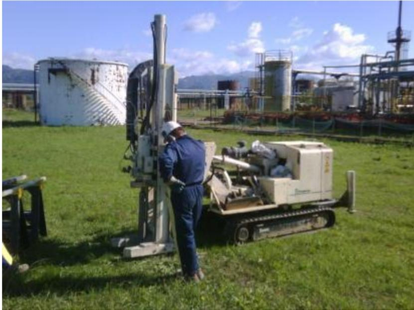
Il sistema Geoprobe si avvale di una sonda di piccole dimensioni con un sistema di perforazione a percussione.
