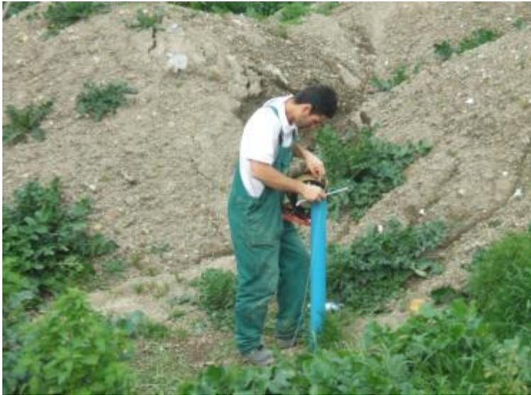
La misura della profondità della falda si effettua nei piezometri installati nei fori di sondaggio.
